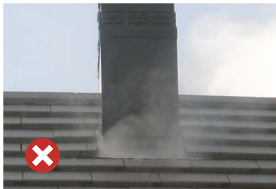
Onbedoelde luchtlekken, waargenomen tijdens blowerdoortest met rookproef.
